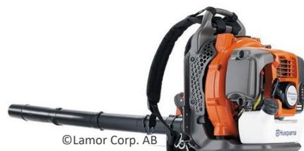
Das LBP 350-Gebläse wird angetrieben von einem 50 cm<sup>3</sup> Zweitakt-Benzinmotor, dessen Geräuschpegel von 94 dB bei 6500 min<sup>-1</sup> der ISO 3744 entspricht. Der X-Torq-Motor bietet mehr Leistung bei reduziertem Kraftstoffverbrauch und geringeren Emissionen. Das Gebläse liefert einen Volumenstrom von 840m<sup>3</sup>/h, so dass auch grosse Ölsperrentypen schnell gefüllt sind.
