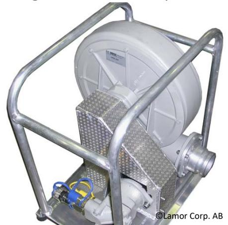
Luftleistung und -druck sind auf die Ölsperren abgestimmt, so dass Beschädigung oder Fehlfunktion der Ölsperre durch zu hohen Fülldruck ausgeschlossen sind. Bei Bedarf kann der Luftstrom zum Entleeren einer Ölsperre umgekehrt werden, indem Ansaugfilter und Füllschlauch an die jeweils andere Kupplung angeschlossen werden.
