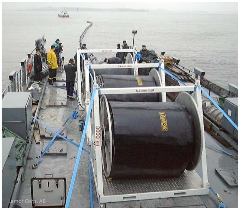
Der Sperrenkörper besteht daher aus zweilagigem Synthetikgewebe, das mit hochwertigem Elastomer zu einer widerstandsfähigen, öl- und ozonbeständigen Einheit vulkanisiert und mit seewasserbeständigen Beschlägen sowie ASTM-Kupplungen versehen wird. Das Füllen mit Luft erfolgt durch ein patentiertes Ventil mit großer Geschwindigkeit.
